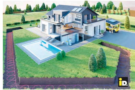
Ringgrabenkollektor ©IDM Wärmepumpen; supaCGI
