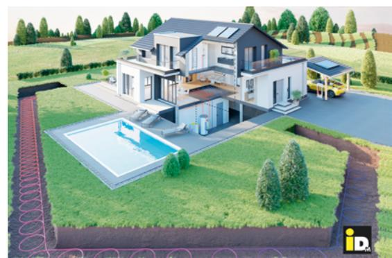
Ringgrabenkollektor ©IDM Wärmepumpen; supacGI
