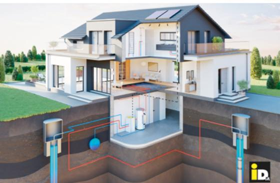
Grundwasser-Wärmepumpe ©IDM Wärmepumpen; supaCGI
