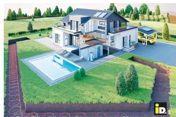
Ringgrabenkollektor ©IDM Wärmepumpen; supacGI
