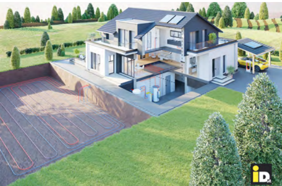
Flachkollektor ©IDM Wärmepumpen; supacgi
